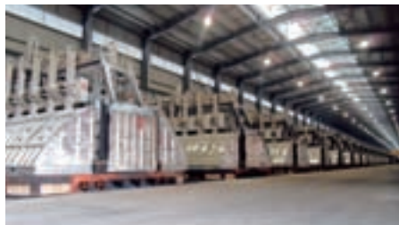
アルミ製錬工場内の電解炉（マレーシア）
